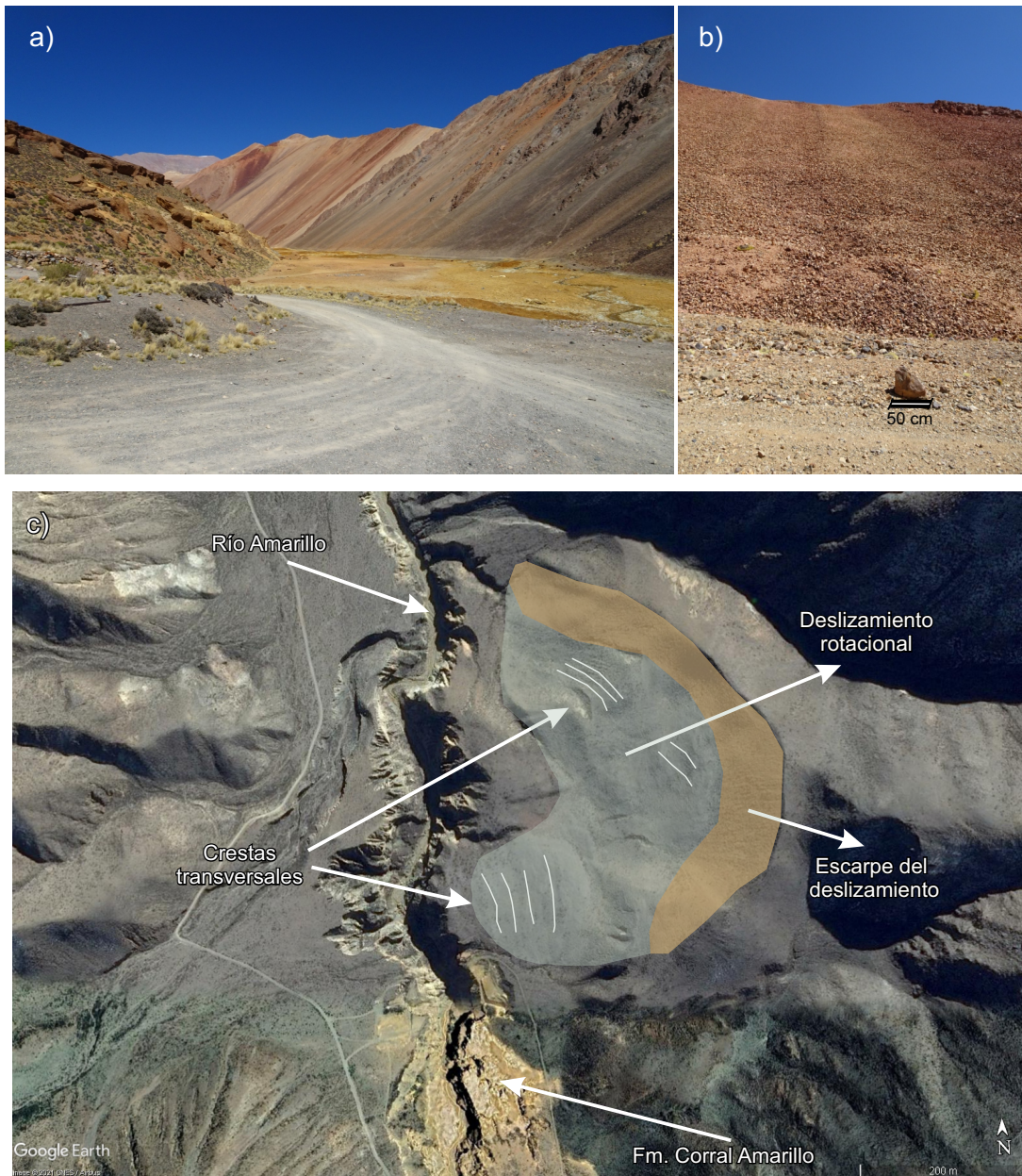
Figura 12. a) Fotografía en la zona del destacamento Cueva de Pérez. En la ladera derecha se pueden observar canchales y conos de derrubios. b) Caída de rocas de diferentes tamaños, en la zona del DMNF. c) Imagen satelital tomada de Google Earth, bajo la Tecnología Image 2021 CNES/Airbus, en donde se puede observar un deslizamiento rotacional, su escarpe principal (cicatriz del deslizamiento), como así también crestas transversales al movimiento del deslizamiento.
