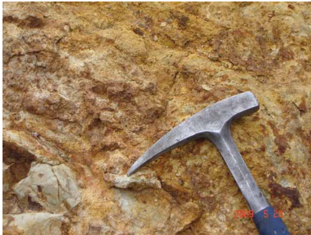
Figura 20. Fotografía mostrando la intensa alteración cuarzo-sericita-pirita, la cual borró la textura y composición original de la roca. En la imagen se puede apreciar la presencia de óxidos de hierro del tipo jarosita ± hematita a partir de la oxidación de sulfuros primarios, así como zonas con aspecto de nódulos, que sugieren una composición félsica para la roca original.
