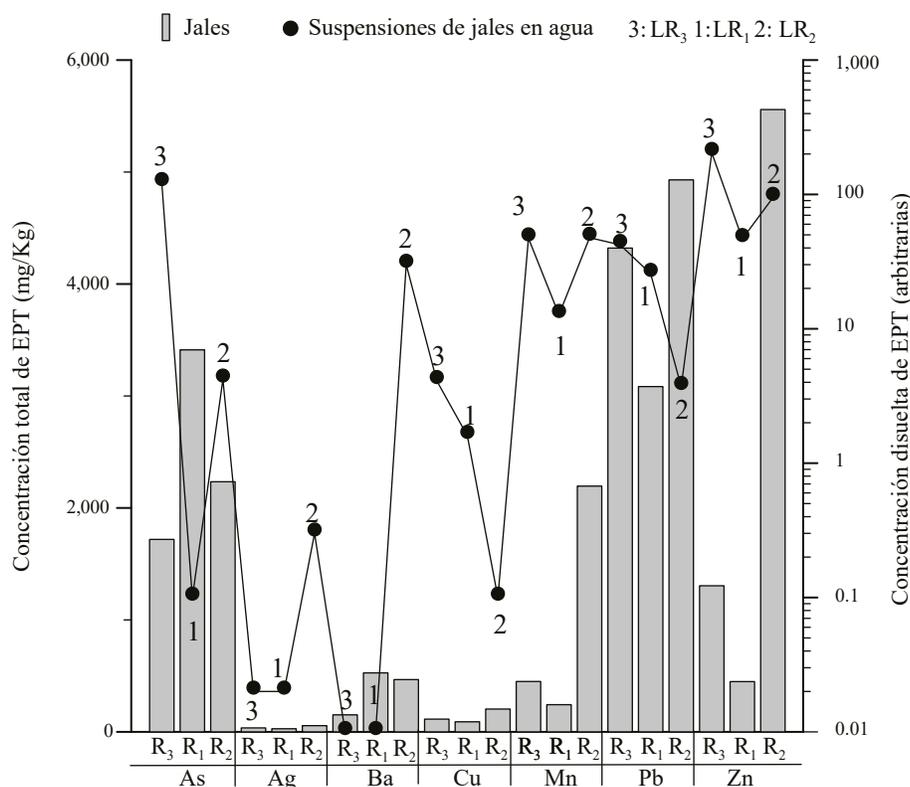
Figura 6. Concentraciones de elementos potencialmente tóxicos (EPT) disueltos en suspensiones de jales en agua (SJA; LR<sub>1</sub>, LR<sub>2</sub>, LR<sub>3</sub>) obtenidas con una relación sólido extractante de 1:3, en función de la concentración total de EPT en jales oxidados (R<sub>1</sub>, R<sub>3</sub>) y jales no oxidados (R<sub>2</sub>).
