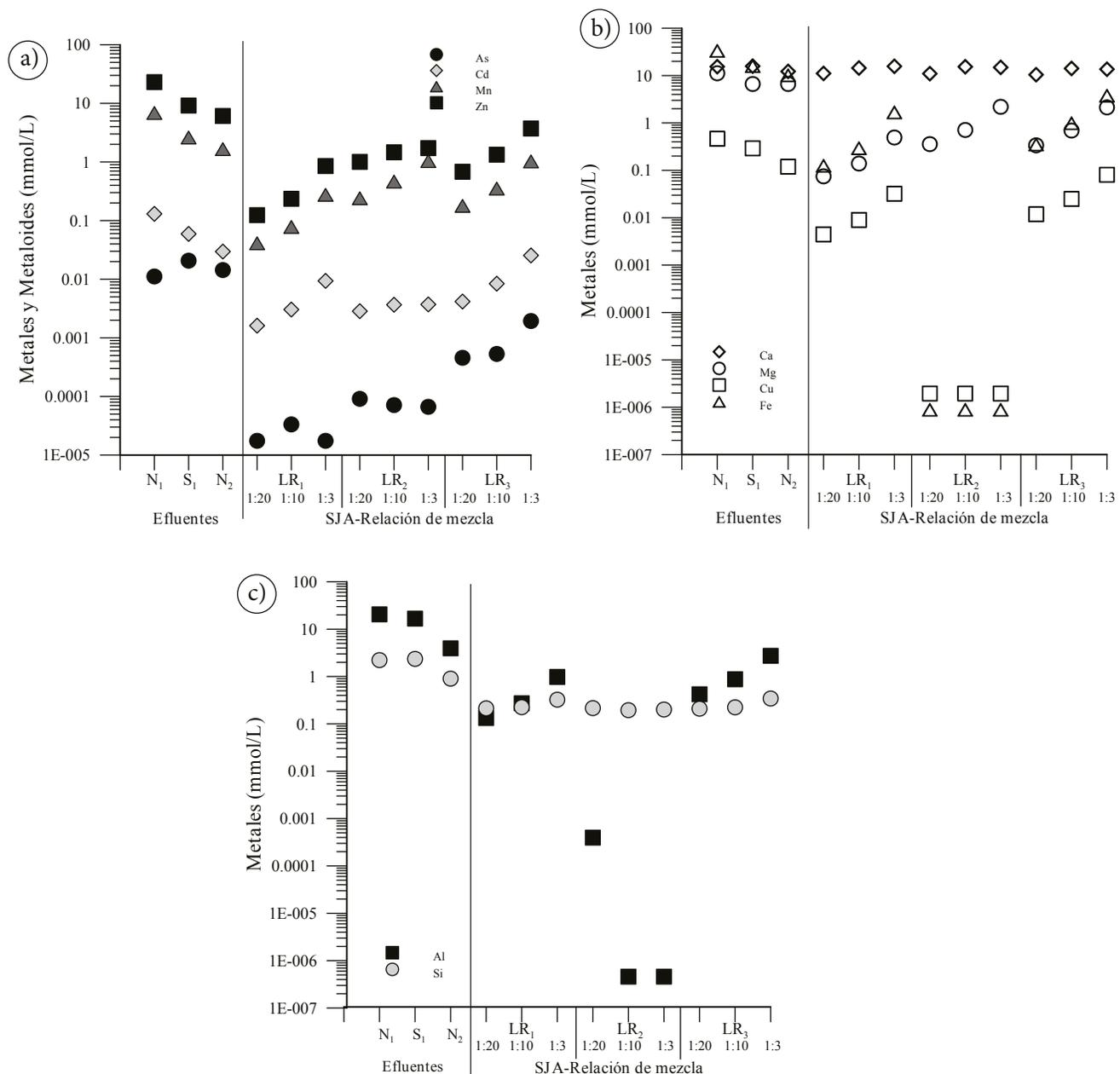
Figura 4. Variación en la concentración de elementos potencialmente tóxicos (EPT) en efluentes ( $N_1$ ,  $S_1$ ,  $N_2$ ) y suspensiones de jales en agua (SJA;  $LR_1$ ,  $LR_2$ ,  $LR_3$ ) generadas con diferentes relaciones de mezcla y tiempo de agitación de  $72 \pm 0.25$  h.
