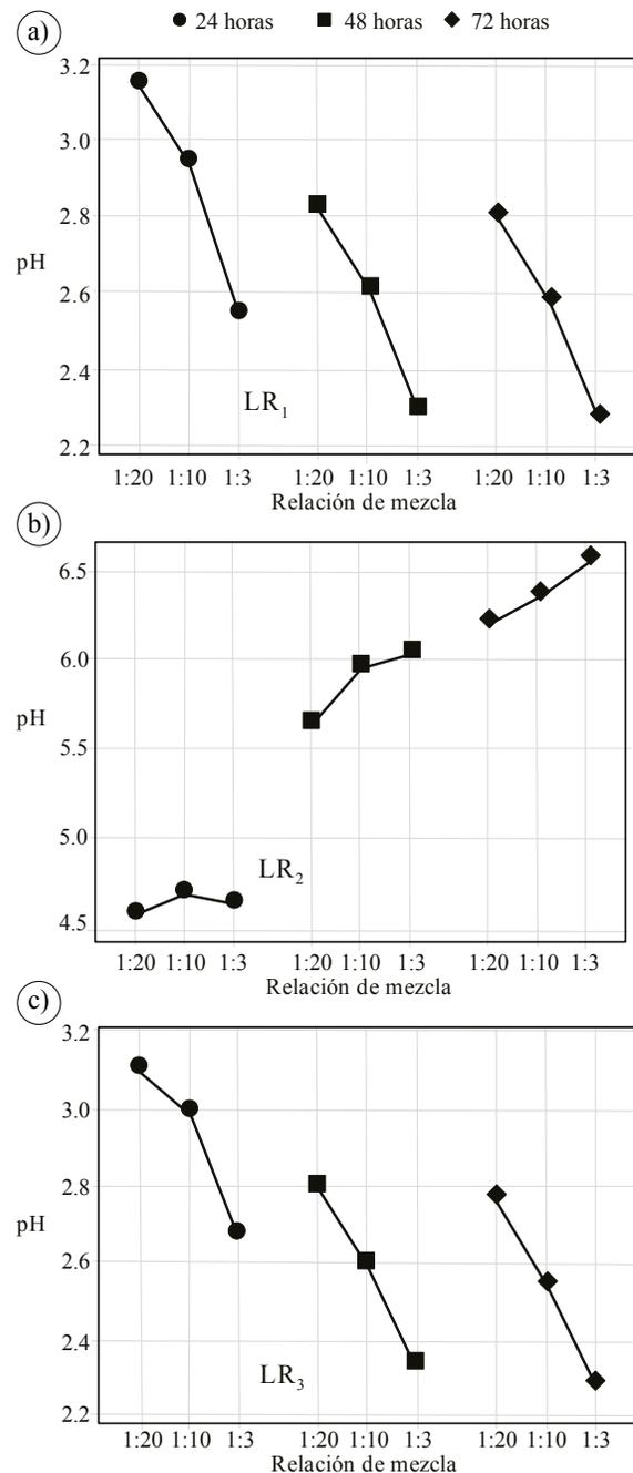
Figura 5. Distribución de los valores de pH en suspensiones de jales en agua (SJA) obtenidas con diferentes relaciones sólido-extractante (1:20, 1:10, 1:3) y tiempos de agitación ( $24 \pm 0.25$  h,  $48 \pm 0.25$  h,  $72 \pm 0.25$  h). a) Distribución de valores de pH en LR<sub>1</sub>, b) Distribución de valores de pH en LR<sub>2</sub>, c) Distribución de valores de pH en LR<sub>3</sub>.
