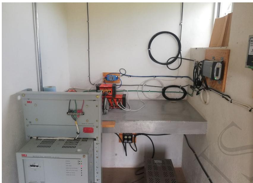
Figura 4. Estación sísmica de Tequisquiapan (TXMV), localizada en el Centro de Enseñanza, Investigación y Extensión en Producción Animal en Altiplano (CEIEPAA), de la Facultad de Medicina Veterinaria y Zootecnia de la UNAM, en Tequisquiapan, Querétaro. Se compone de un sensor STS-2, un digitalizador Q330 y un acelerógrafo Episensor. Los datos se comparten con el SSN y con el Consorcio IRIS.
